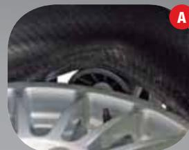
● Il **DISCO GRANDE** consente il sollevamento del pneumatico e il distacco del tallone inferiore. ● **The LARGE DISC lifts the tyre and detaches the lower bead.** ● Die **GROSSE SCHEIBE** gestattet das Anheben des Reifens und das Lösen des unteren Wulsts.
